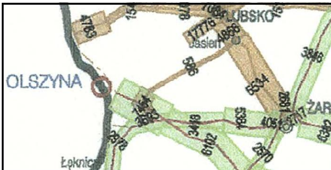
Mapa. Średni dobowy ruch pojazdów silnikowych na drogach krajowych i wojewódzkich w 2005 roku w rejonie Tuplic 56 .
